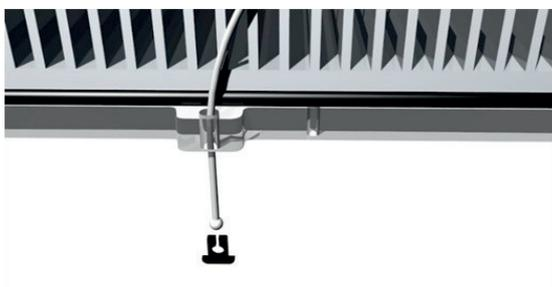
Applicare le clips fornite alle terminazioni a sfera e inserire l'assemblato nel foro della lente facendo scorrere indietro il cavetto di acciaio e premendo contemporaneamente sulla testa della clip.
